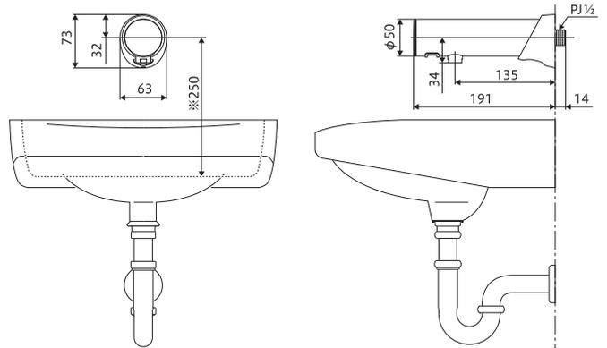
※誤作動防止のため、水栓取り付け穴から洗面器底面までは250mm以上を確保してください。
